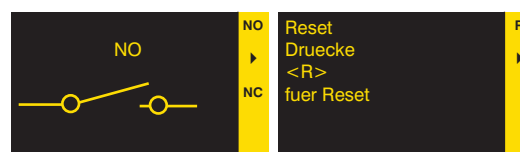
Abb. 2: Öffner/Schließer einstellen Abb. 3: Reset durchführen
