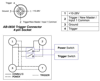
AB-0830 Wiring Diagram
